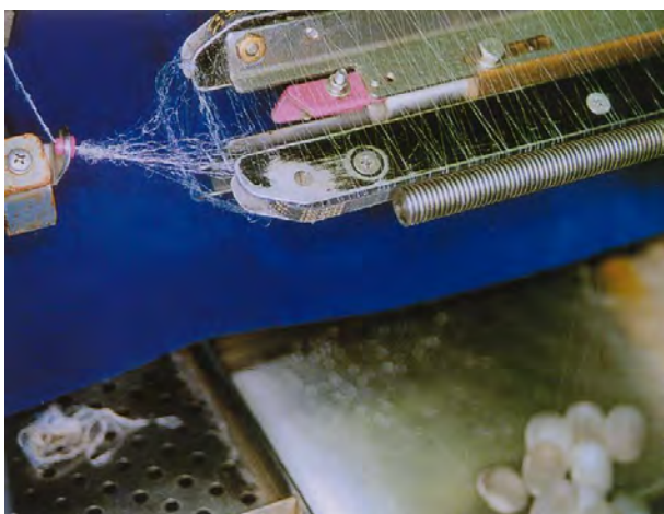
写真 2-10-2 ネットロウシルクの繰糸状態 糸が網状になり、かさ高な糸になる。
