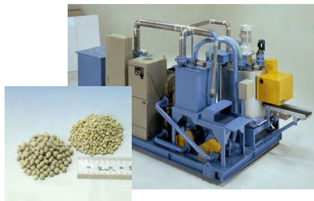
写真 2-11-6 農業集落排水汚泥の石灰処理装置および製造肥料 (1998)
