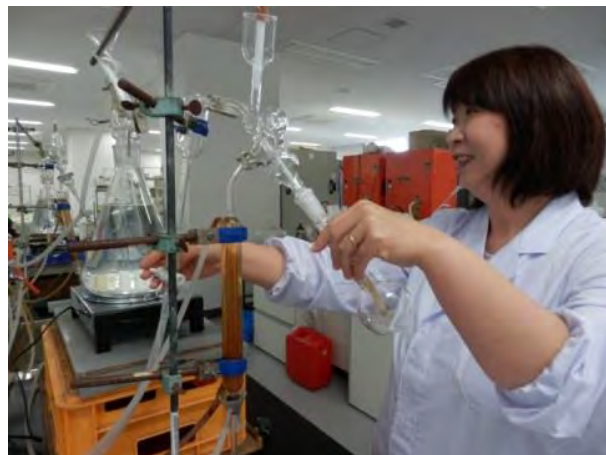
写真 2-11-13 蒸留による窒素の分析作業
