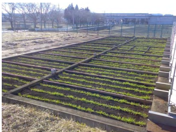
写真 2-11-11 人工圃場における小麦のカドミウム吸収試験(2007) 土壌類型、カドミウム水準、塩化物水準が設定された
