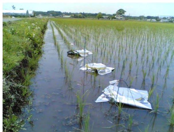
写真 2-11-3 現地水田での脱窒速度の測定 (2007)
