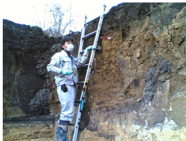
写真 2-11-2 露頭での深層の物理性測定試料の採取 (2008)
