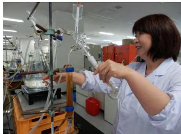
写真 2-11-13 蒸留による窒素の分析作業
