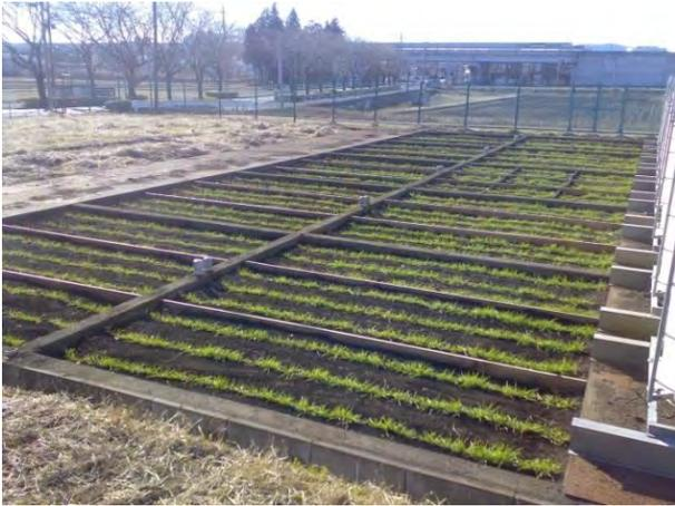
写真 2-11-11 人工圃場における小麦のカドミウム吸収試験(2007)
