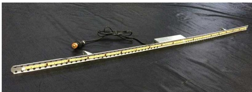
第8図 キク花芽分化抑制用赤色 LED電照装置 試作機
