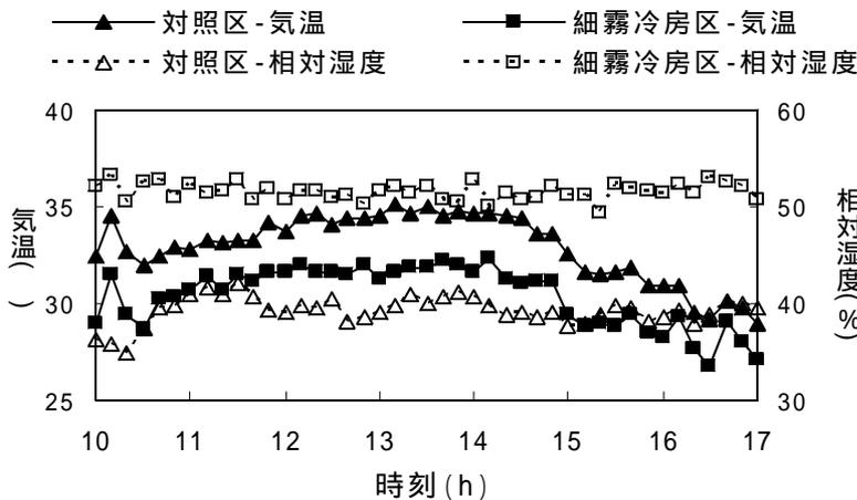
図 - 3 細霧冷房処理が気温と相対湿度に及ぼす影響 (5月9日)
