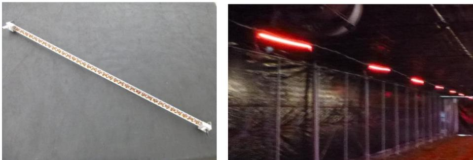
図-2 改良した赤色 LED 電照装置 (左) とほ場設置の様子 (右)
