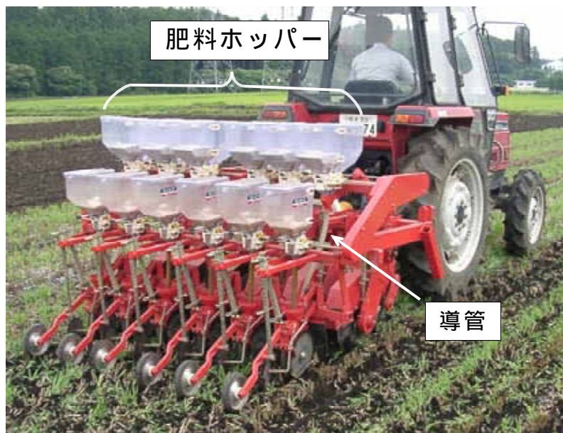
図1-9 不耕起播種機の肥料ホッパー
