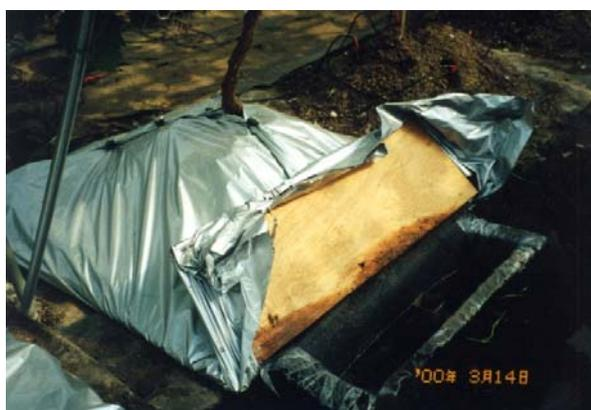
第7図 樹体吸水量および排水量測定装置
