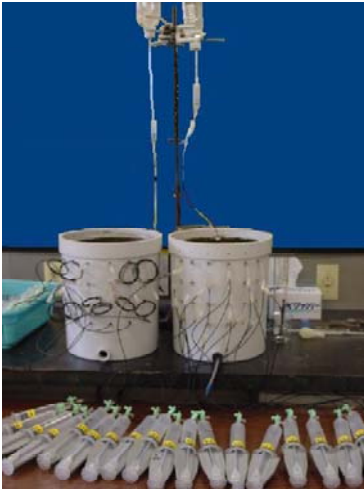
写真-1 点滴かん水における水の浸潤動態測定状況
