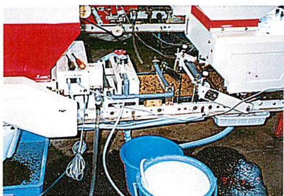
写真-2 サッカー 2分割方式灌注装置
